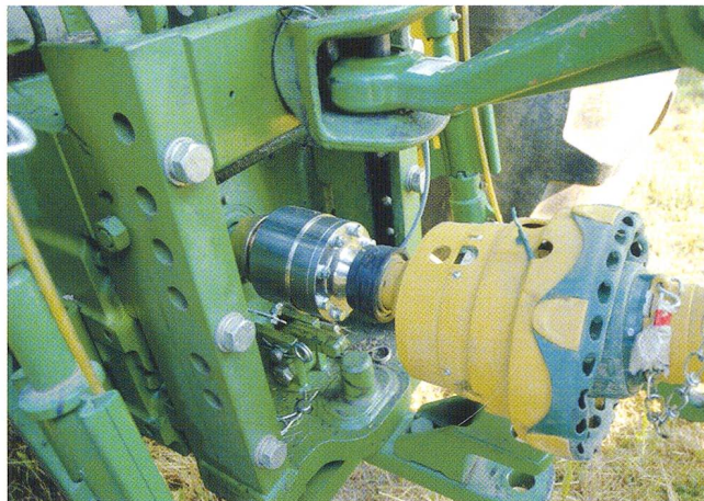
Fig. 7: Un mesureur de couple relève la puissance nécessaire pendant le pressage.
