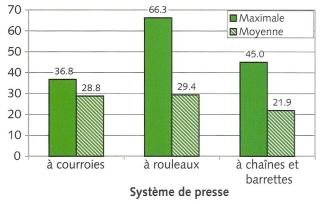
Fig. 12: Les presses à rouleaux exigent de grosses réserves de puissance de la part du tracteur. C'est la presse à courroies et à barrettes qui demande le moins de puissance nécessaire en moyenne.
