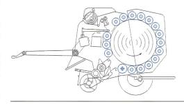
Fig. 3: Des rouleaux rotatifs constituent le cœur de la presse à rouleaux.
