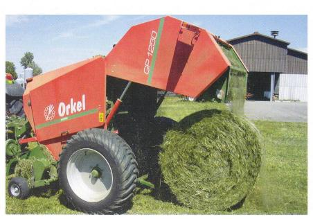
Fig. 1: Lors du pressage du foin et suivant le système de presses, les pertes de fourrage peuvent être comprises entre 0,5 et 2,6 %.
