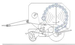
Fig. 4: Deux chaînes continues, reliées par des barrettes transversales, compactent le fourrage.
