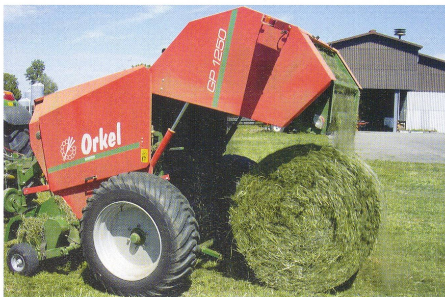
Fig. 1: Lors du pressage du foin et suivant le système de presses, les pertes de fourrage peuvent être comprises entre 0,5 et 2,6 %.
