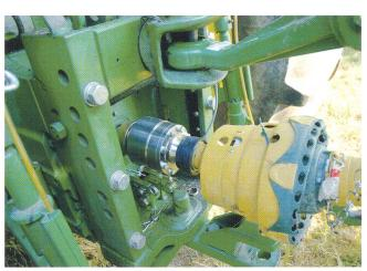
Fig. 7: Un mesureur de couple relève la puissance nécessaire pendant le pressage.
