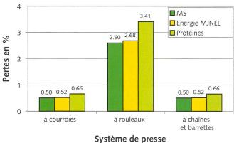
Fig. 10: Etant donné la concentration plus forte d'éléments nutritifs dans les pertes, ces dernières apparaissent plus élevées si on les exprime en quantité d'éléments nutritifs, plutôt qu'en poids.
