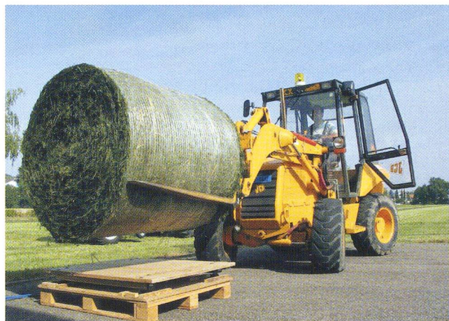
Fig. 8: Pour déterminer le poids des balles, les balles rondes sont déposées sur une plate-forme de pesée à l'issue du pressage.
