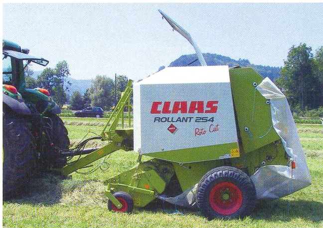
Fig. 5: Un film récupère les pertes par brisure qui surviennent pendant le pressage.
