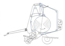
Fig. 2: Avec les presses à courroies, le compactage se fait à l'aide de cinq à six courroies continues en caoutchouc.
