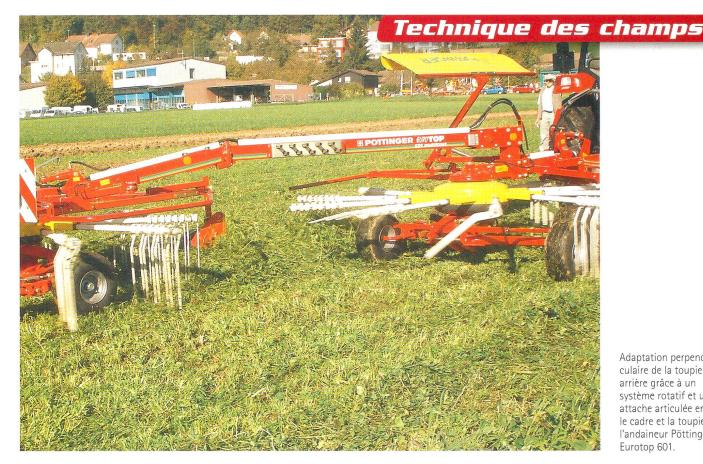
Adaptation perpendiculaire de la toupie arrière grâce à un système rotatif et une attache articulée entre le cadre et la toupie de l'andaineur Pöttinger Eurotop 601.
