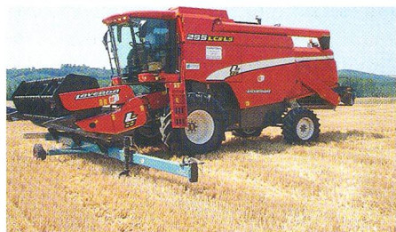
Le nouveau modèle 255 LCS de la série INTEGRALE de LAVERDA . Avec une compensation latérale de 20% et longitudinale de 8%, cette moissonneuse-batteuse remplira la plupart des exigences. Le moteur INVECO NEF garanti une puissance suffisante; la barre de coupe est équipée de l' APS pour le guidage.
