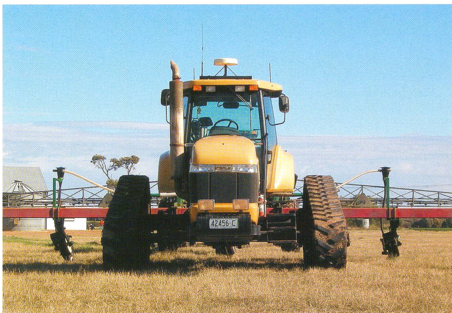
Illustration 3. Avec le «Controlled Traffic Farming», tous les véhicules circulent année après année dans les mêmes traces, guidés par GPS au centimètre près. En Australie, ce principe est très répandu. Un tel système pourrait-il contribuer à réduire le compactage des sols en Suisse aussi?
