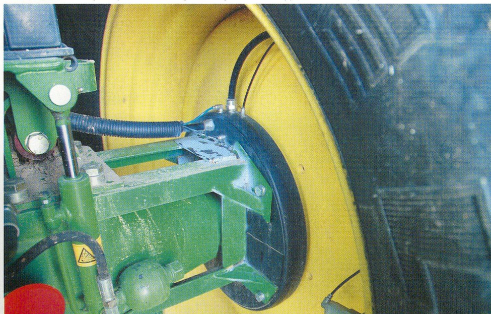
Illustration 2. Le gonflage intégré permet de régler la pression des pneus en roulant. Les tuyaux extérieurs, qui dépassaient la largeur des garde-boue, appartiennent au passé.
