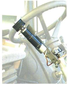
Illustration 1. Prototype d'un système automatique de guidage pour l'arboriculture de l'Agroscope Reckenholz-Tänikon ART. A gauche, un essai dans des lignes de pommiers. A droite, le mécanisme fixé au volant.
