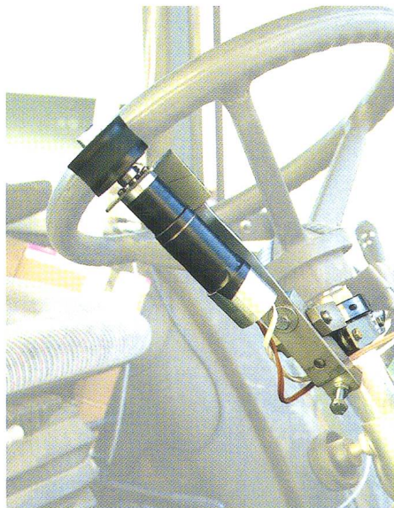
Illustration 1. Prototype d'un système automatique de guidage pour l'arboriculture de l'Agroscope Reckenholz-Tänikon ART. A gauche, un essai dans des lignes de pommiers. A droite, le mécanisme fixé au volant.
