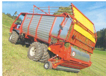
Autochargeuse Aebi LD49: Le pick-up oscillant est poussé et s'adapte à toutes les irrégularités de terrain.
