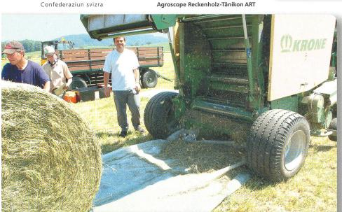
La presse à rouleaux en tant que presse à chambre constante nécessite une puissance augmentant progressivement jusqu'à près de 66 kW lors de l'enrubannage. Les presses à courroies utilisent une puissance relativement constante aux alentours de 30 kW du début du processus de pressage jusqu'à l'enrubannage.
