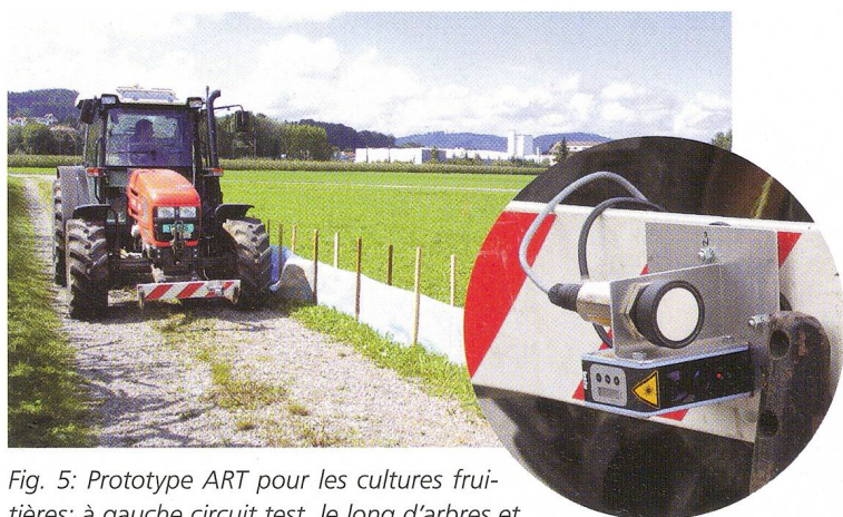
Fig. 4: Systèmes de guidage parallèle sans GPS: à gauche détecteur à ultra-sons de Reichhardt-Steuerungstechnik pour l'identification des voies de passage, à droite caméra Eco-Dan pour le guidage de la sarcluse entre les lignes.
