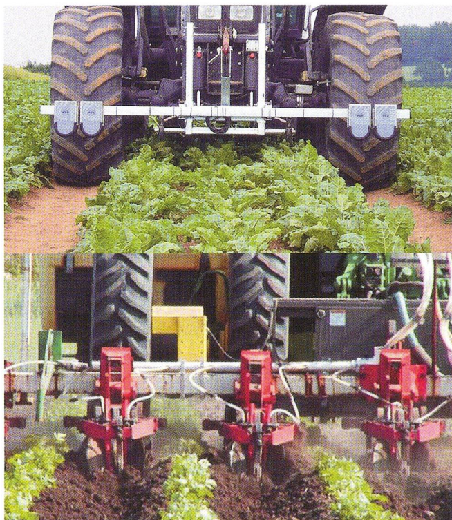
Fig. 4: Systèmes de guidage parallèle sans GPS: à gauche détecteur à ultra-sons de Reichhardt-Steuerungstechnik pour l'identification des voies de passage, à droite caméra Eco-Dan pour le guidage de la sarcluse entre les lignes.
