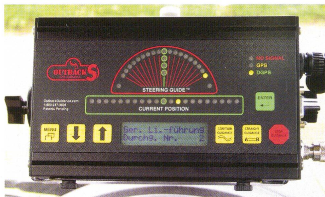
Fig. 6: Systèmes de guidage parallèle manuels avec indicateur lumineux: à gauche Centerline 220 de LH Agro, à droite Outback S d'Agrocom.
