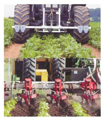
Fig. 4: Systèmes de guidage parallèle sans GPS: à gauche détecteur à ultra-sons de Reichhardt-Steuerungstechnik pour l'identification des voies de passage, à droite caméra Eco-Dan pour le guidage de la sarcleuse entre les lignes.
