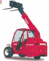
Le nouveau Twisco SLT 420 B de Manitou est un vrai costaud grâce à ses 50 CV et sa puissance de levage de deux tonnes.
