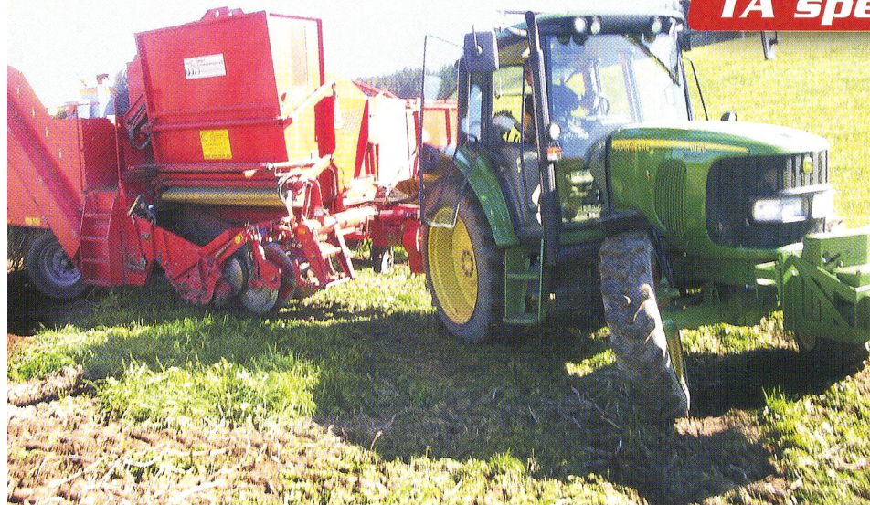
Des manœuvres facilitées pour tourner en bout de champ grâce au timon articulé de la récolteuse totale.
