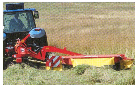
Faucheuse Fella – SM 310 TL-KC, avec conditionneur à doigts.
