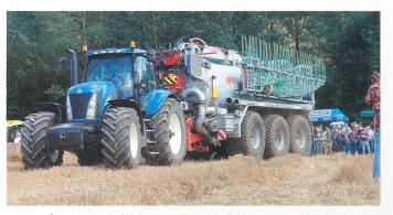
Ce tonneau de fabrication allemande Briri a une capacité de 22 400 litres pour une largeur d'épandage de 21 mètres.
