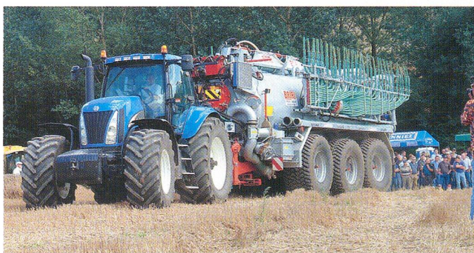
Ce tonneau de fabrication allemande Brii a une capacité de 22 400 litres pour une largeur d'épandage de 21 mètres.
