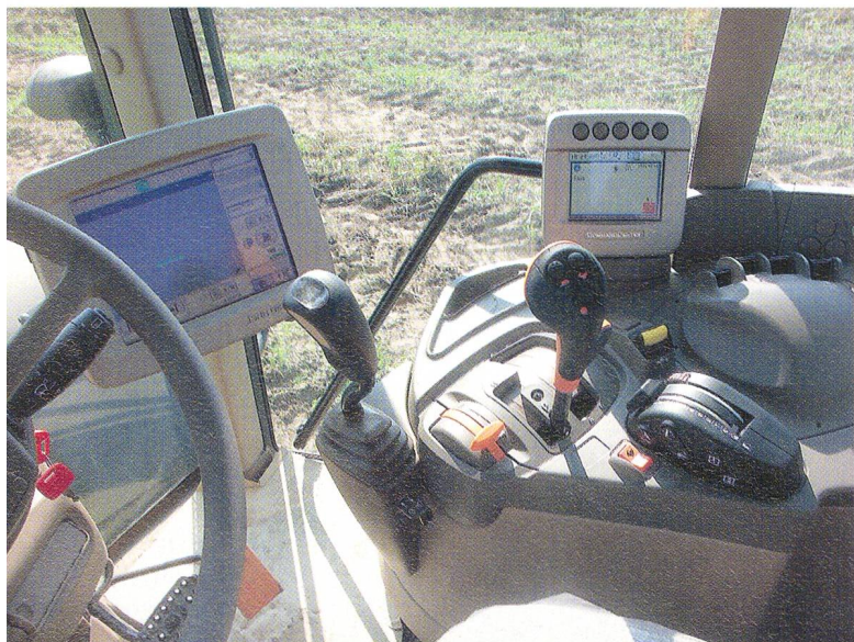
Nouvel équipement de la cabine Premium avec CommandCenter à droite et terminal ISO-BUS à gauche.
