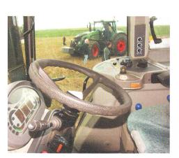
Eléments de commande clairement disposés de la nouvelle série 300 Vario avec la sphère multifonctions sur la console de droite qui permet de commander la transmission Vario. A l'arrière-plan, la série 900 Vario attire l'attention.
