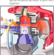
La combustion se fait et le piston travaille. L'air du carter du vilebrequin est comprimé et de la pression est exercée
