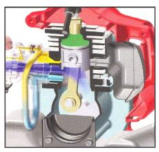
Le piston comprime le gaz dans la chambre de combustion. De l'air est aspiré dans le carter du vilebrequin.
