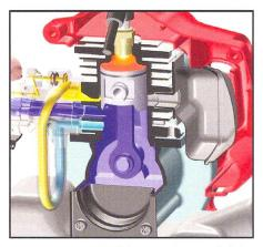
Le carter du vilebrequin s'est rempli d'air, alors que le canal de carburant s'ouvre. Le gaz est enflammé peu avant le point mort supérieur.
