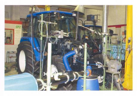
peut arriver qu'un tracteur avec le même moteur ait soudain plus de puissance qu'auparavant, si l'on en croit les indications du prospectus. L'indication n'est pas nécessairement erronée. On a seulement utilisé une autre norme pour tester la puissance du véhicule. Néanmoins, le tracteur supposé plus puissant ne fournit pas pour autant plus de kW à la prise de force. Or, c'est ce qui compte pour l'agriculteur.
