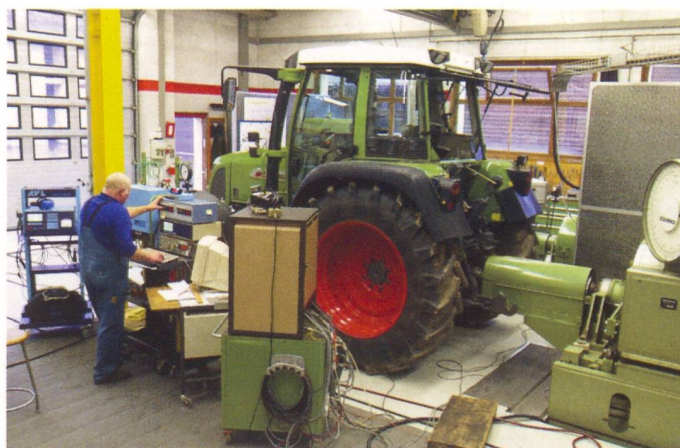
Fig. 1: Agroscope FAT Tänikon mesure la puissance à la prise de force. Cette puissance est la puissance réellement disponible pour les outils entraînés à la prise de force.
