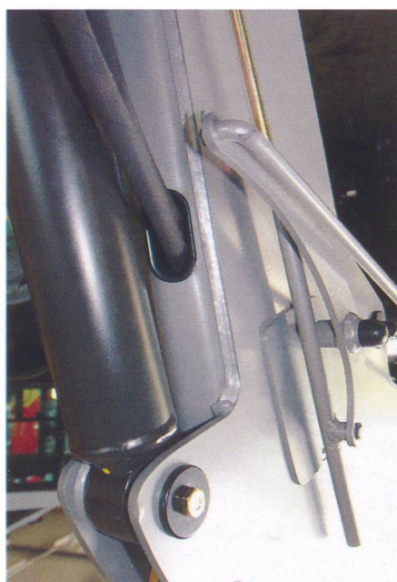
Une des caractéristiques de la nouvelle gamme: tous les tuyaux sont intégrés aux bras du chargeur.
