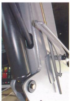
Une des caractéristiques de la nouvelle gamme: tous les tuyaux sont intégrés aux bras du chargeur.
