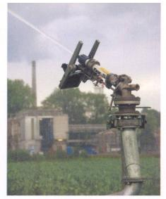
Le canon à eau. Lorsqu'il est branché sur un enrouleur, c'est la solution la plus simple pour irrgiuer de grandes surfaces. Il est toutefois assez sensible au vent et demande une pression et un débit élevés pour fonctionner. Il permet d'atteindre une pluviométrie élevée, jusqu'à 20 mm/h.
