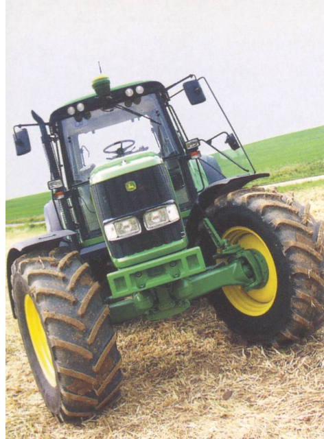
Le StarFire iTC – Le récepteur prend la pente en considération pour l'indication du milieu du tracteur sur la surface du sol.
