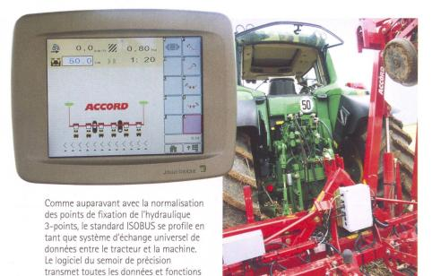
...par exemple, le levage unilatéral de l'agrégat de semis en bord de champ. La machine est reliée au tracteur par un circuit hydraulique. La répartition du flux d'huile hydraulique dans le semoir est régulée par une soupape de commande électromagnétique.
