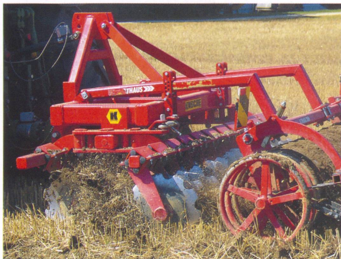
Ill. 3: Les herse à disques indépendants travaillent en surface (5 cm), ne bourrent pas et sont très efficaces. Leur acquisition est assez onéreuse, ce qui implique un taux d'utilisation en conséquence.
