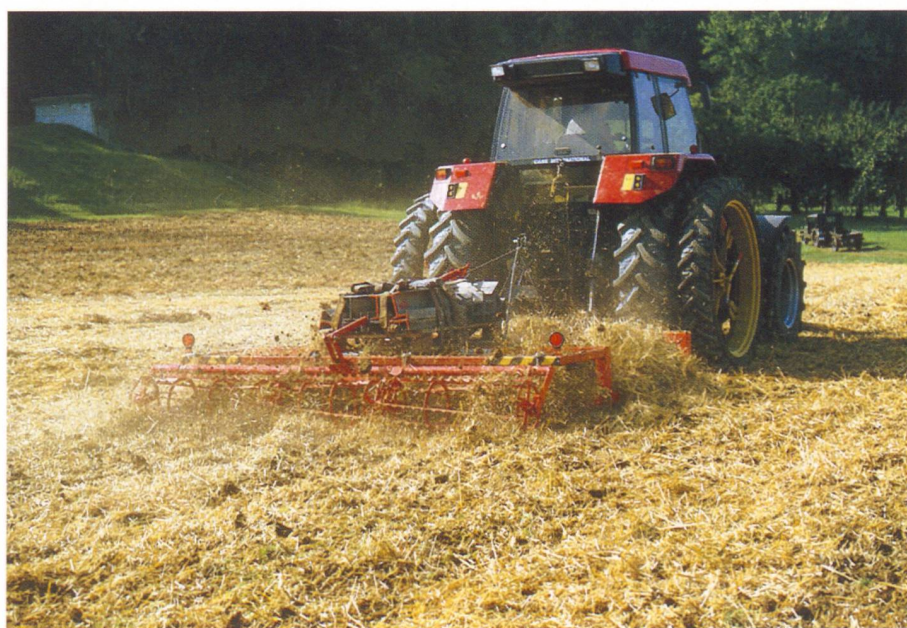
Ill. 5: Les herse à bèches roulantes mélangent la paille en surface, ont un rendement élevé et un faible besoin en force de traction. Comme elles ne travaillent pas le sol sur toute sa superficie, elles présentent quelques faiblesses quant à la lutte contre les adventices.
