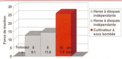
Graphique: Les besoins en force de traction (3 m de largeur de travail) de la herse à disques indépendants (Knoche) et du cultivateur à socs bombés (Rabe EG 11 avec barre niveleuse). En raison de leur profondeur de travail réduite, la herse à disques indépendants a nécessité moins de force de traction que le cultivateur à socs bombés. Dans tous les cas, les besoins augmentent de manière plus que proportionnelle avec la profondeur (10 kN correspondent à env. 1 tonne de force de traction).
