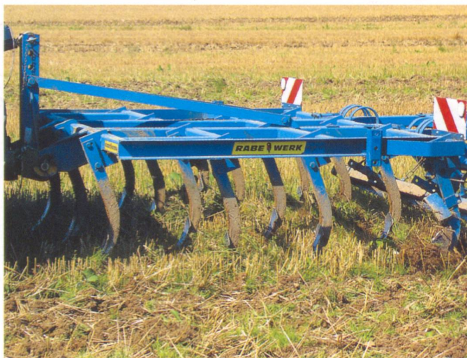
Ill. 4: Les cultivateurs à socs bombés traditionnels sont particulièrement bien adaptés pour le mélange de la paille à des profondeurs de travail avoisinant les 15 cm. Pour un travail moins profond, il s'agit de monter des socs en patte d'oie.
