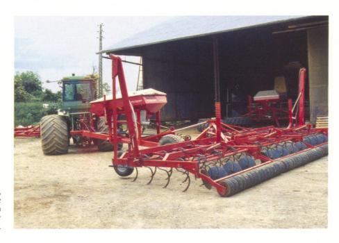
III. 2: Lorsque la paille est soigneusement évacuée, la vieille herse à dents vibrantes convient pour le déchaumage. La firme française Agri-Structures a développé une combinaison de semis à partir d'une telle herse.
