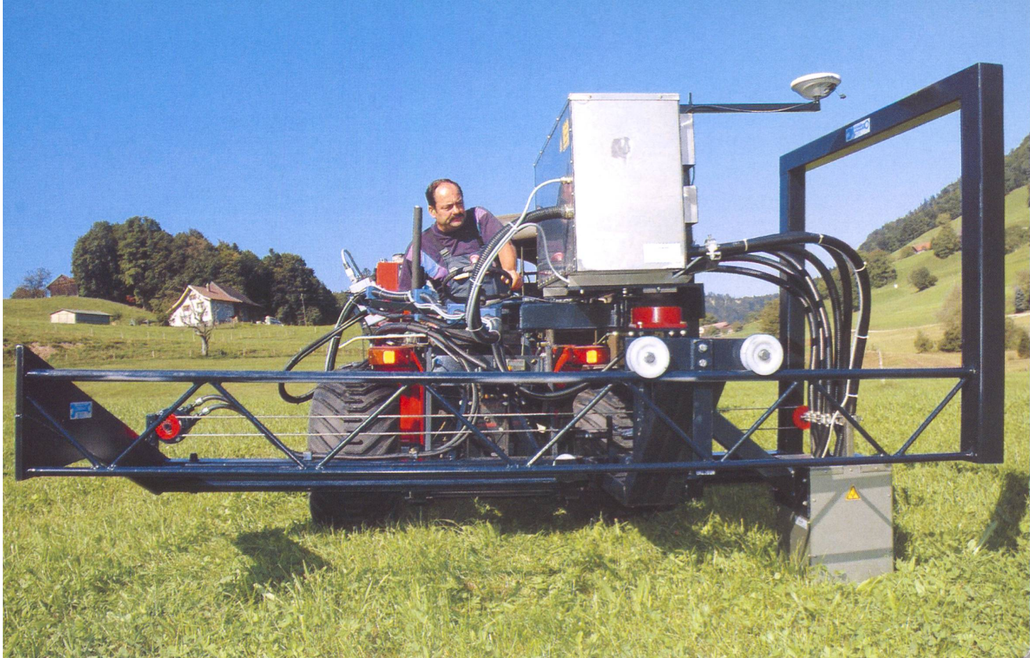
Prototype de lutte contre le rumex par micro-ondes monté sur un petit tracteur. L'antenne GPS permet de déterminer au centimètre près la position de la plante traitée, ce qui sert au contrôle ultérieur.
