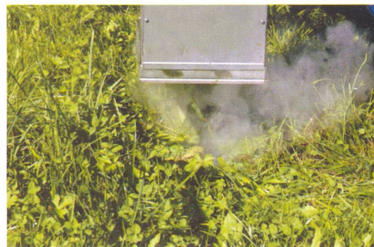
Grâce aux micro-ondes, les racines des rumex riches en eau peuvent être traitées spécifiquement.
