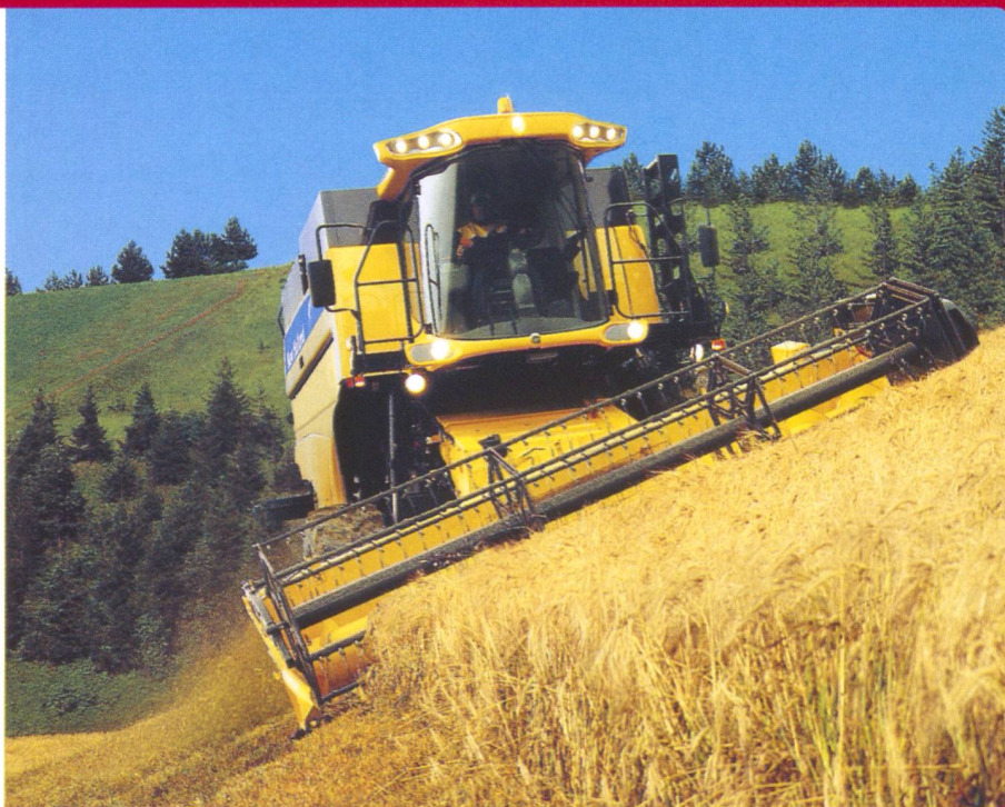
Moissonneuse-batteuse New Holland CL 560 avec système hydraulique de compensation du châssis latérale et longitudinale.
