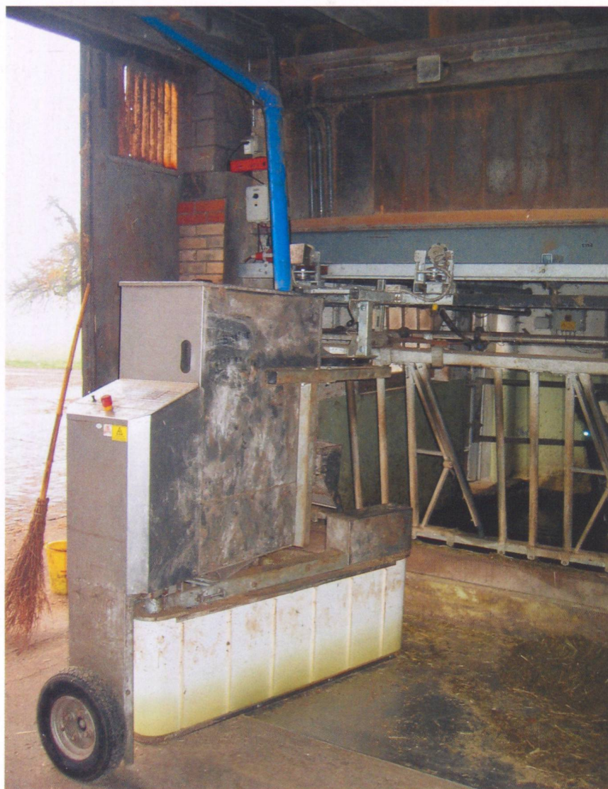
Fig. 2: Le remplissage du Butler-Plus se fait de préférence de manière entièrement automatique par l'intermédiaire d'un système d'alimentation (tuyau bleu). En position de parking, le chargeur recharge les accus du Butler.
