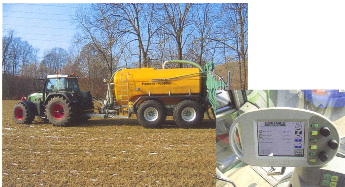
La maison Hadorn a résolu le guidage de la citerne à lisier de Zunhammer par le terminal Vario de Fendt.
