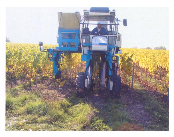
spéciaux disposant de la traction quatre roues et d'une transmission hydrostatique. Pour la mécanisation du travail du sol, des soins de l'enherbement, de l'effeuillage, de la fumure et des traitements, une grande variété d'outils portés est disponible. Ils peuvent se monter à l'avant, de côté ou à l'arrière. Grâce aux vendangeuses, la récolte du raisin est aujourd'hui complètement mécanisable.
