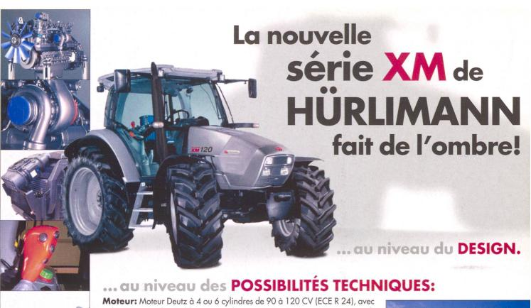
**Moteur:** Moteur Deutz à 4 ou 6 cylindres de 90 à 120 CV (ECE R 24), avec turbo et intercooler. Le bloc-moteur de construction étroite permet une excellente maniabilité; radiateur de refroidissement compacte et escamotable sans outils; réglage électronique du moteur (EMC) et Tempomat; performances constantes et couple-moteur constant dès 600 t/min; régime du moteur abaissé à 1800 t/min à 40 Km/h.
