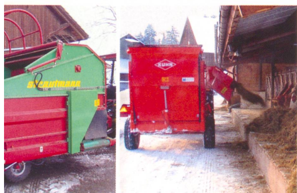
Fig. 2: Deux différents types de systèmes coupe-balles: système avec couteau en forme d'épée (photo de gauche); les fourches à désiler qui possèdent un angle d'ouverture suffisamment grand peuvent couper les balles rondes (photo de droite).
