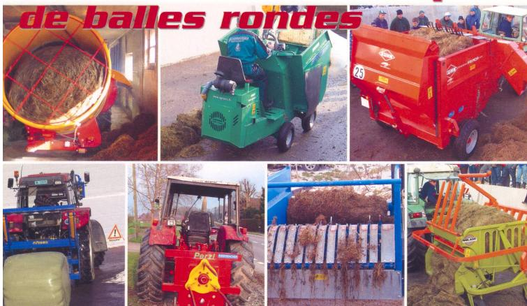
Fig. 1: Différents outils facilitent l'ouverture des balles rondes et la distribution du fourrage. Pour choisir l'outil qui convient, il faut tenir compte de la taille du troupeau, des possibilités et du taux d'utilisation, de la ration de fourrage, du mode de stockage, de la technique d'affouragement en place, des machines de traction et de la place disponible sur l'exploitation.
