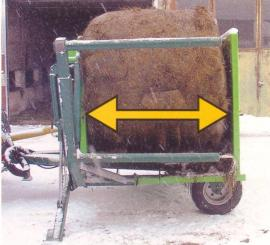
Fig. 7: Lorsque les balles rondes d'ensilage trop mouillées sont empilées couchées, elles se déforment et s'écrasent (photo de gauche); du fait de leur volume intérieur limité, les dérouleurs de balles fermés ne tolèrent que les balles rondes non déformées (photo de droite).
