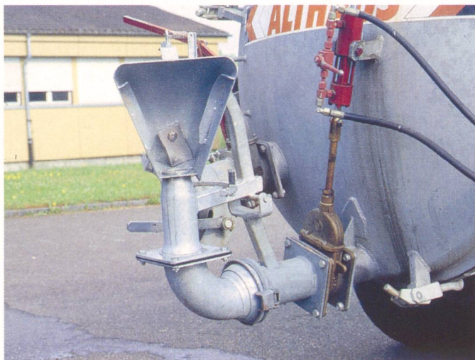
Les déflecteurs oscillants constituent une alternative intéressante aux déflecteurs classiques: ils produisent des grosses gouttes et permettent une répartition précise sur une largeur importante.
