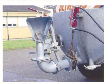
Les déflecteurs oscillants constituent une alternative intéressante aux déflecteurs classiques: ils produisent des grosses gouttes et permettent une répartition précise sur une largeur importante.
