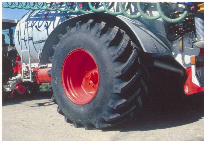
Moyennant des aménagements spécifiques pour leurs roues, les citernes de grand volume peuvent ménager le sol, sans dépasser la largeur maximale autorisée.
