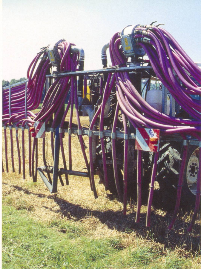
Les systèmes d'épandage à tuyaux souples avec deux têtes de distribution à rotor verticales assurent une répartition régulière sur l'ensemble de la surface de travail.
