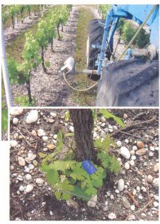
Pour l'épamprage, les têtes peuvent se fixer à l'avant. La pulvérisation ne se déclenche que si le capteur infrarouge détecte une plante. Le produit n'est pulvérisé que sur le végétal détecté.
