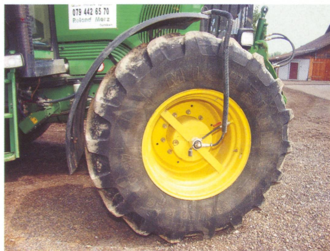
Un dispositif de télégonflage. Ici, les risques d'arrachage sont assez élevés. Il existe aussi des systèmes dont toutes les conduites s'intègrent dans les moyeux.
