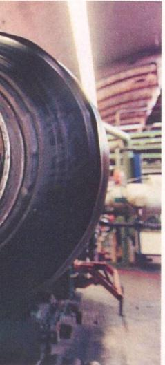
Un pneu de tracteur à l'état de pneu vert, sur le tour où il vient de recevoir la bande de roulement.
