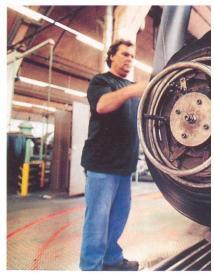
La pièce de l'image précédente est introduite dans un four un peu semblable à un moule à gaufre géant. Ici, à la fin de la cuisson, le pneumatique est terminé.
