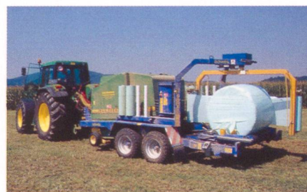
La technique des balles d'ensilage est très flexible. Le pressage et l'enrubannage sont en général réalisés par un entrepreneur et ne mobilisent donc que peu la mains-d'œuvre de l'exploitation.
