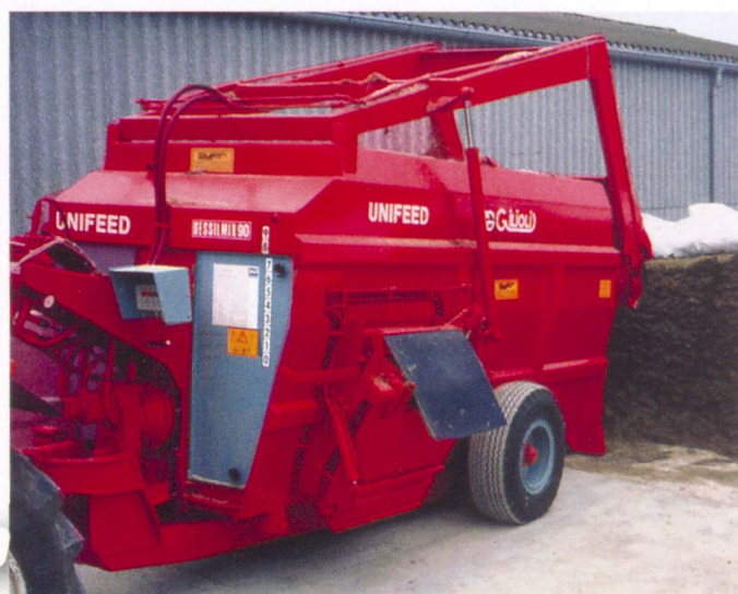
Pour la distribution de l'ensilage, des machines coûteuses comme la désileuse-mélangeuse sont, si possible, à utiliser en commun.
