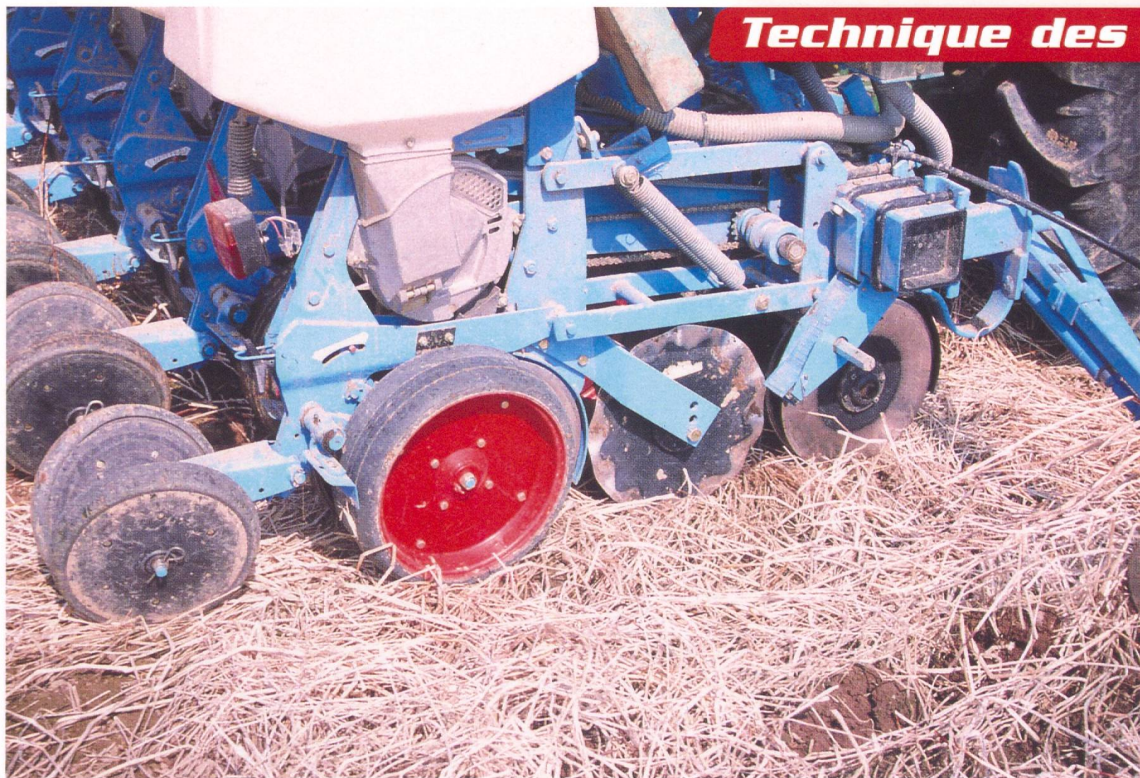
Semis direct dans un peuplement de moutarde gelé. Seuls des machines spéciales lourdes sont appropriées pour le semis direct, un sol suffisamment sec étant par ailleurs nécessaire. (photo: SFZ)
