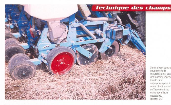
Semis direct dans un peuplement de moutarde gelé. Seuls des machines spéciales lourdes sont appropriées pour le semis direct, un sol suffisamment sec étant par ailleurs nécessaire. (photo: SFZ)
