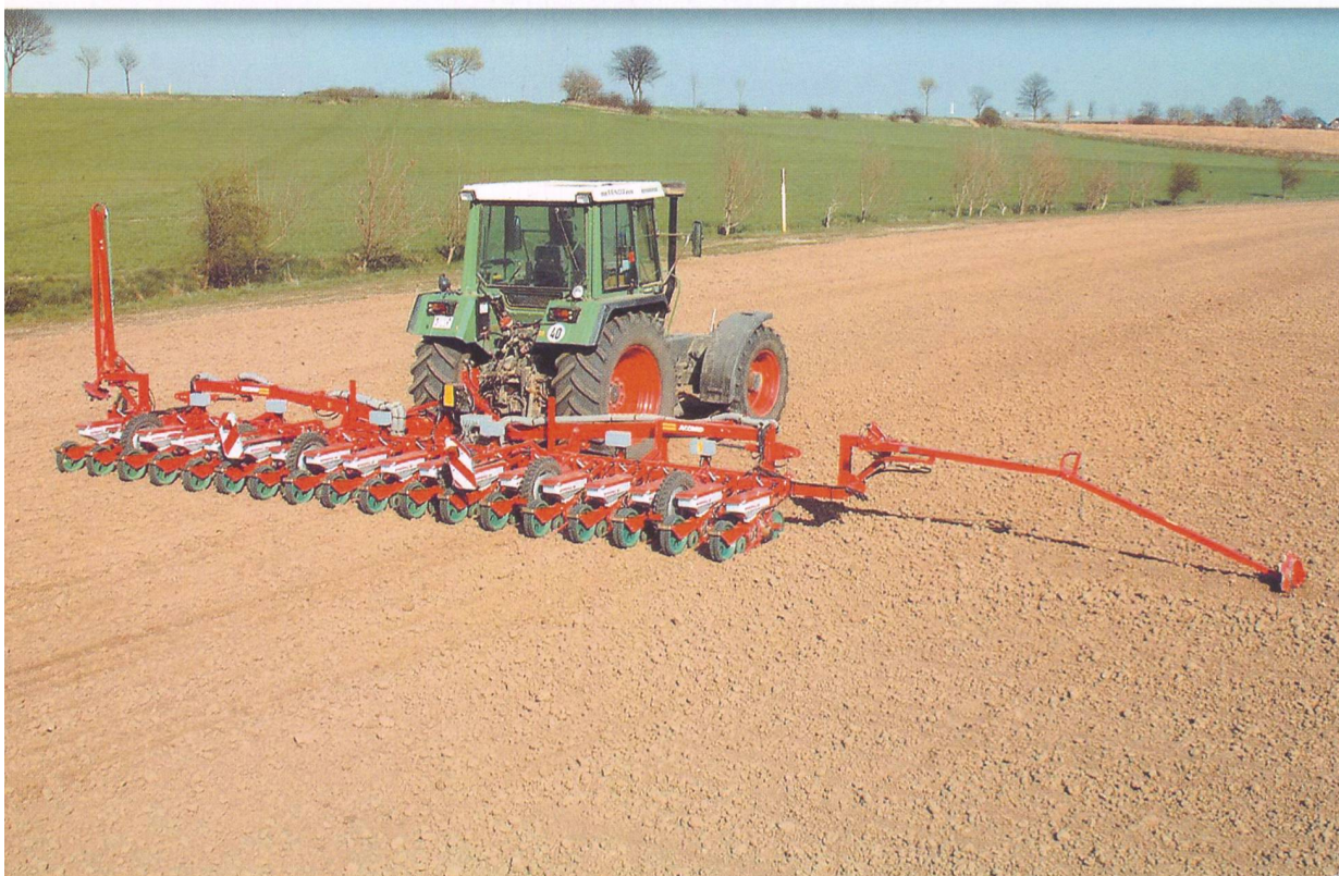
Largeur de travail importante avec un semoir de précision grâce à un poids réduit (photo: m.à.d.)
