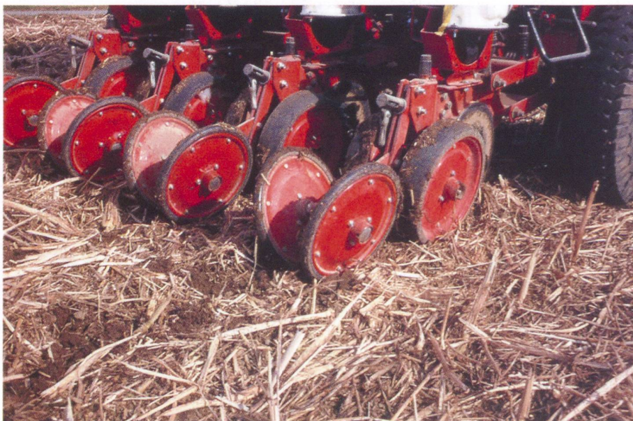
Semoir de semis direct «multifonctions» Semeato lors du semis dans un champ de radis fourrager gelé. (photo: Stefan Wyss)
