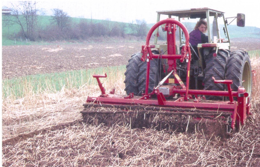
Travail superficiel des résidus de plantes, par exemple avec cultivateur ou herse rotative à axe horizontal. (photo: SFZ)
