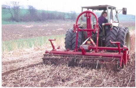
Semoir lourd pour semis sous litière avec épandeur d'engrais intégré. (photo: Stefan Wyss)
