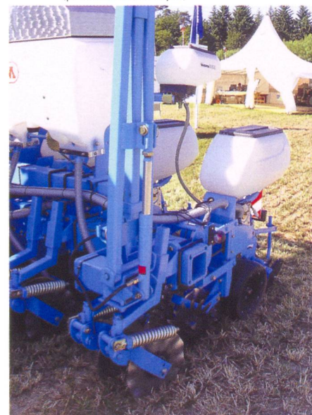
Semoir lourd pour semis sous litière avec épandeur d'engrais intégré. (photo: Stefan Wyss)
