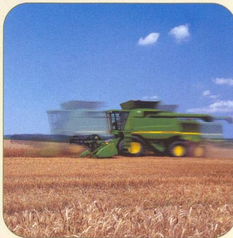
*Le contrôle automatique de la vitesse d'avancement "HarvestSmart" surveille en permanence la charge du moteur et du séparateur, ainsi que les pertes de grain afin de maintenir le flux d'alimentation à une vitesse optimale. Pour désactiver le système lors des manœuvres en bout de champ, il vous suffit de tirer le levier hydraulique vers vous.*
