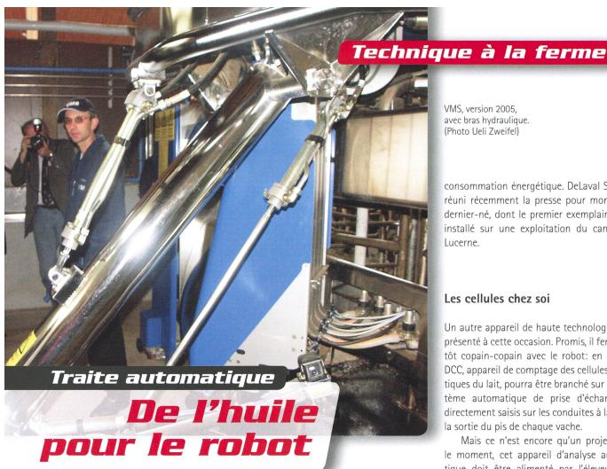
Le principal fabriquant d'installations de traite a modernisé son robot. DeLaval propose un entraînement hydraulique sur le bras de la version 2005 du VMS. La filiale suisse du groupe a également présenté sa politique opérationnelle, qui tranche avec celle imposée par la direction suédoise.
