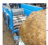
Göweil, dérouleur de balles, dès CHF 8000.-\* Göweil S.à r.l., 4950 Huttwil Entraînement hydraulique, hauteur de déchargement jusqu'à 100 cm, poids à vide 600 kg, largeur 215 cm
