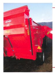
Kuhn Primor 3560, CHF 27 380.— Agriott, 3052 Zollikofen Entraînement: mécanique, régulation électronique (potentiomètre), raccord hydraulique à double fonction, porte de chargement ou chargeur frontal, Lo×La×H (cm): 394×220×230. Autres possibilités d'utilisation: Epandage de paille jusqu'à 18 m, balles rondes ou carrées, ainsi que fourrage en vrac, commande électrique, entraînement, Polydrive®, commande supplémentaire de la porte de chargement
