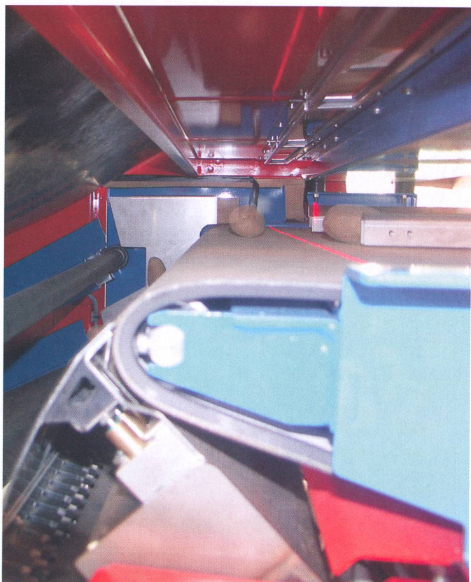
Samro: Toujours spécialiste absolu de la manutention des pommes de terre, malgré l'abandon de la construction de récolteuses totales. Ici, aperçu du calibrage photométrique des tubercules dans une armoire à infrarouge permettant le tri par le biais d'un dispositif pneumatique.
