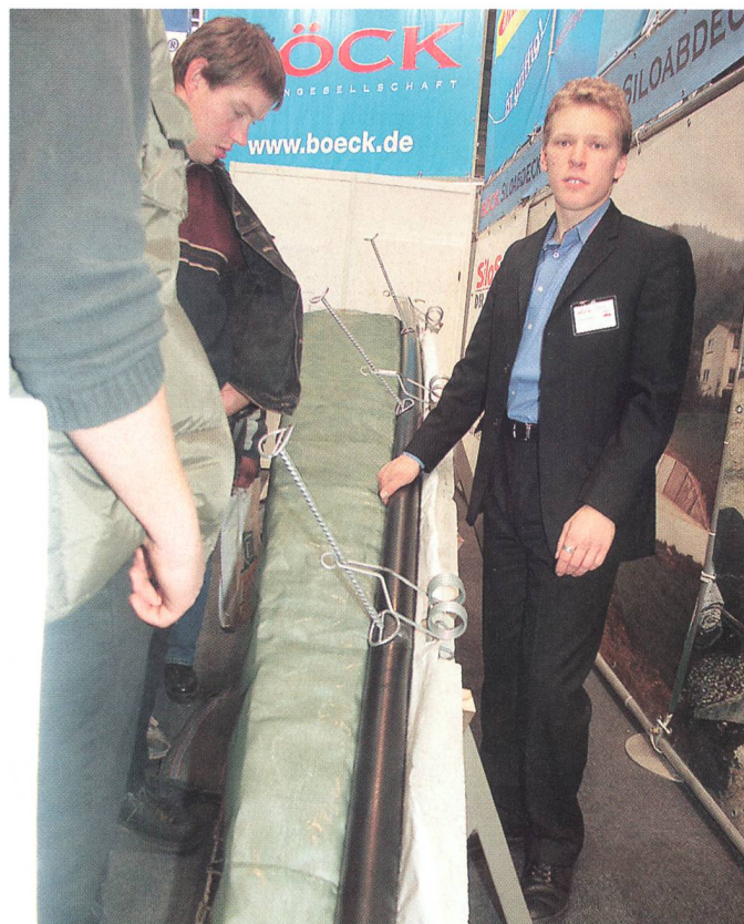
La firme Böck à Trostberg (D) exposait un système de tension simple remplaçant les sacs de sable pour l'étanchéité des silo-tranchées. Ce système peut aussi être installé après coup.
