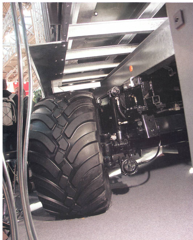
Nouvelle remorque à poussoir Fliegl avec un châssis permettant de déplacer l'essieu depuis le tracteur, afin de modifier le poids d'appui selon la situation de travail et de l'adapter pour le transport routier.
