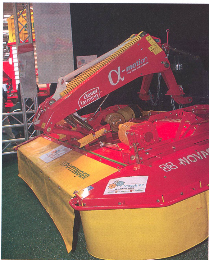
Nouveau dispositif de coupe de Pöttinger avec technologie et géométrie optimisées permettant une adaptation parfaite aux irrégularités du sol en terrain accidenté.
