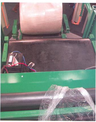
En collaboration avec la firme Orkel, Baltensberger AG, Brütten ZH, met sur le marché un système d'attache par feuille plastique plutôt que filet pour les balles d'ensilage. Celle-ci ne remplace pas de l'enrubannage proprement dit, mais facilite la manipulation lors de la libération de la balle.
