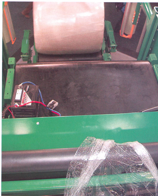
En collaboration avec la firme Orkel, Baltensberger AG, Brütten ZH, met sur le marché un système d'attache par feuille plastique plutôt que filet pour les balles d'ensilage. Celle-ci ne remplace pas de l'enrubannage proprement dit, mais facilite la manipulation lors de la libération de la balle.
