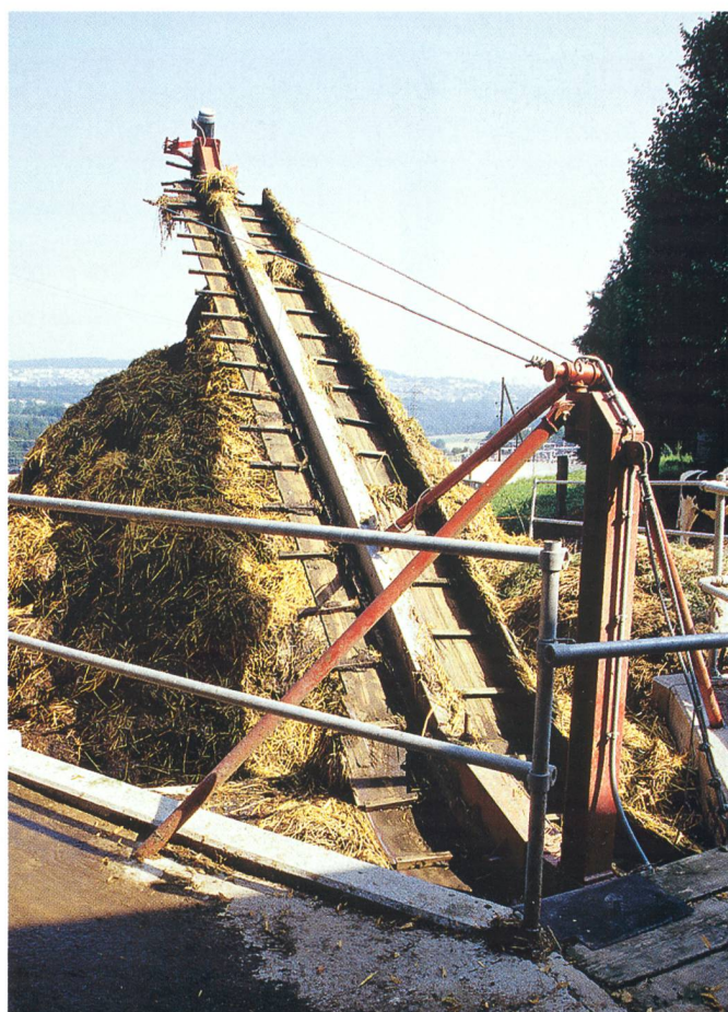
Élévateur à fumier avec installation de sécurité.
