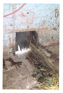
Si l'installation présente des endroits dangereux ou des goulets en aval (espaces de sécurité inférieurs aux prescriptions) comme par exemple des canaux fermés, une fosse à lisier contiguë, des ouvertures de chargement des évacuateurs taupe, à vis sans fin, à pression ou à élévateur, il faut alors équiper l'installation d'interrupteurs de sécurité tels que listes de contact, barrages immatériels, archets ou commande à action maintenue, etc.
