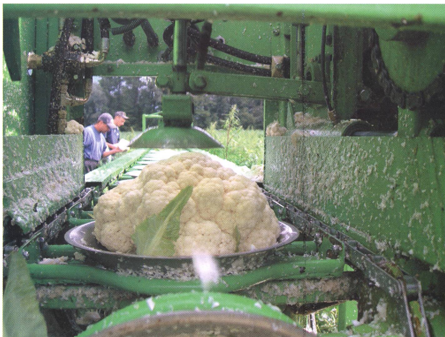
Vie intérieure d'une machine belge: la cloche ne va pas tarder à appuyer sur le chou-fleur et une «foreuse» va évider le tronc. Les rosettes se détachent et sont amenées par tapis roulant sur des paloxes pour être blanchies, emballées et surgelées à -18 °C. (Photo: Beni Dürr)
