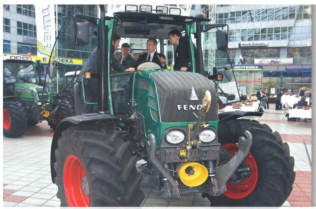
Tout nouveau: le Fendt 312, équipé d'une transmission Vario en continu. Le tracteur, d'un poids de 4390 kg, développe une puissance de 125 CV.
