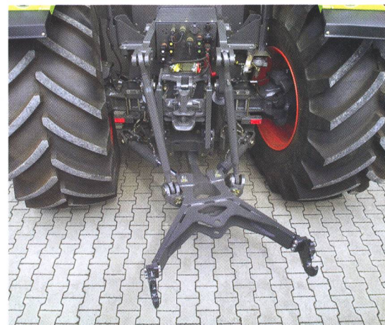
Le Claas Xerion avec relevage arrière pivotant pour la compensation en marche en crabe (photo usine).
