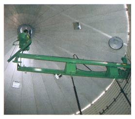
Agritechnica laisse la vedette à la technique des champs. Cependant, l'offre dans le domaine de la ferme et de la logistique interne de l'exploitation s'avère aussi pléthorique. Par exemple: échoir à ensilage de Neuero avec volume de stockage et fonction de séchage. Les brasseurs sont actionnés par entraînement forcé et montés sur un cadre porteur (photo usine).
