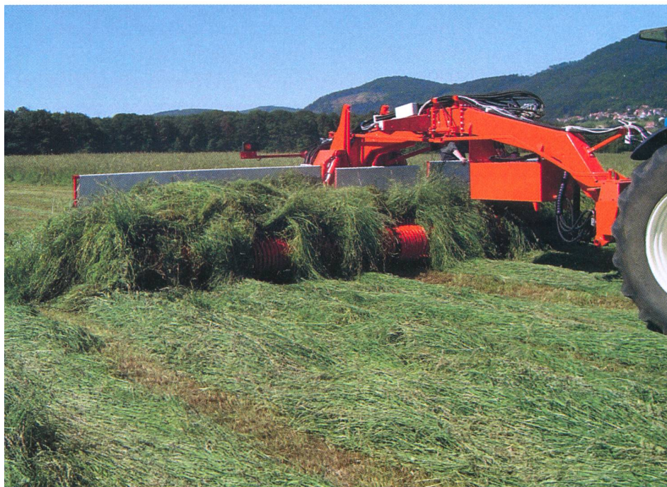
L'andaineur à bandes KUHN entraîne le fourrage en douceur au milieu, à droite ou à gauche (photo usine).
