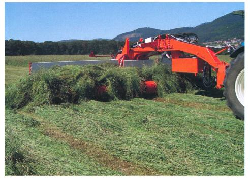
L'andaineur à bandes KUHN entraîne le fourrage en douceur au milieu, à droite ou à gauche (photo usine).
