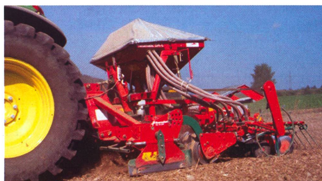
Fig. 2: Dans tous les procédés, la préparation du lit de semences a été faite avec une herse rotative à axes verticaux. Afin de semer les céréales en respectant une distance de 25 cm entre les lignes dans la culture BIO, une ouverture sur deux était fermée par un insert dans la tête de distribution du semoir pneumatique.
