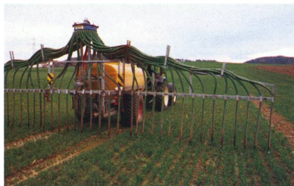
Fig. 3: Le lisier a été épandu (à gauche) à l'aide d'une rampe d'épandage à tuyaux souples, tandis que les engrais minéraux (à droite) ont été épandus à l'aide d'un distributeur pneumatique.
