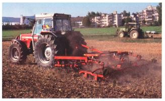
Fig. 10: Les herses à disques indépendants, conviennent parfaitement pour les cures anti-adventices. Lorsque la paille a été enlevée correctement après les céréales, le traditionnel vibroculteur (à droite) fait également du bon travail.
