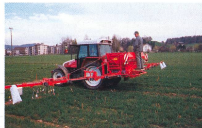
Fig. 3: Le lisier a été épandu (à gauche) à l'aide d'une rampe d'épandage à tuyaux souples, tandis que les engrais minéraux (à droite) ont été épandus à l'aide d'un distributeur pneumatique.
