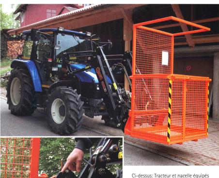
Ci-dessus: Tracteur et nacelle équipés conformément aux prescriptions et permettant de travailler en toute sécurité en hauteur.
