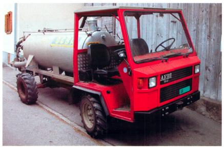
Fig. 2: Le Aebi TP 47 avec citerne à pression portée a été utilisé pour représenter la petite combinaison avec transporteur.
