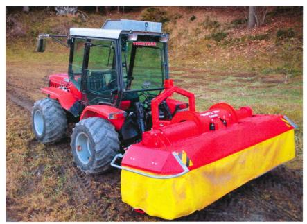
Fig. 3: La combinaison avec faucheuse à deux essieux était constituée d'un tracteur réversible Antonio Carraro Tigretrac 5500 avec ou sans dispositif de coupe frontal 2,6 m.
