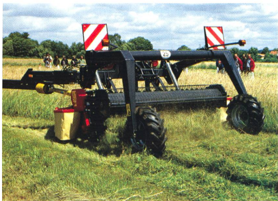
Faucheuse tractée Vicon HPC avec conditionneuse à brosse intégrée et rouleau d'épandage large.
