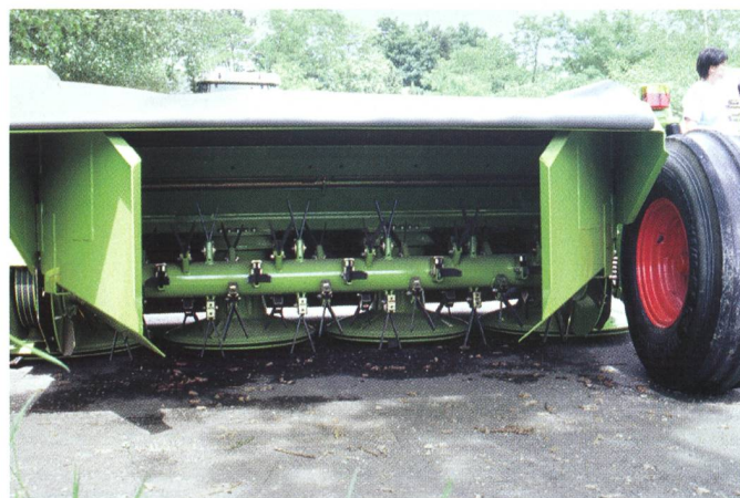
Faucheuse à tambour avec conditionneuse à battoirs oscillants intégrée.
