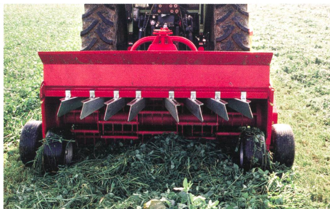
Kurmann K 618 TWIN: L'épandage large du fourrage conditionné intensivement se fait à l'aide de huit déflecteurs réglables.
