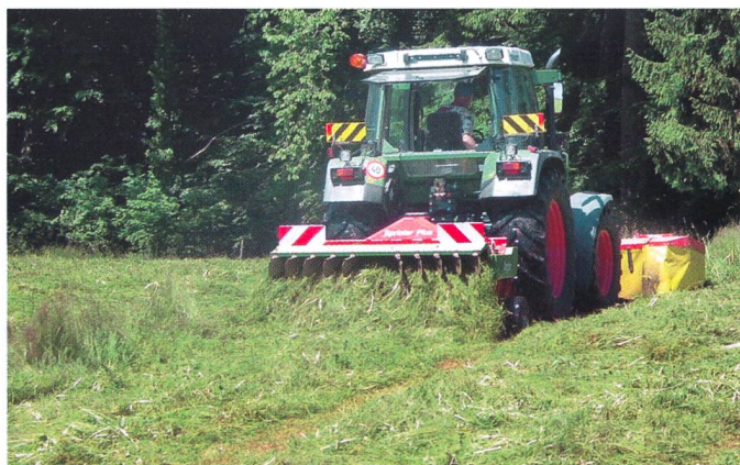
Conditionneuse tractée Sprinter Plus de GVS-Agrar avec rouleau à brosse pour le conditionnement intensif.
