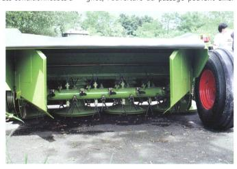
Faucheuse à tambour avec conditionneuse à battoirs oscillants intégrée.
