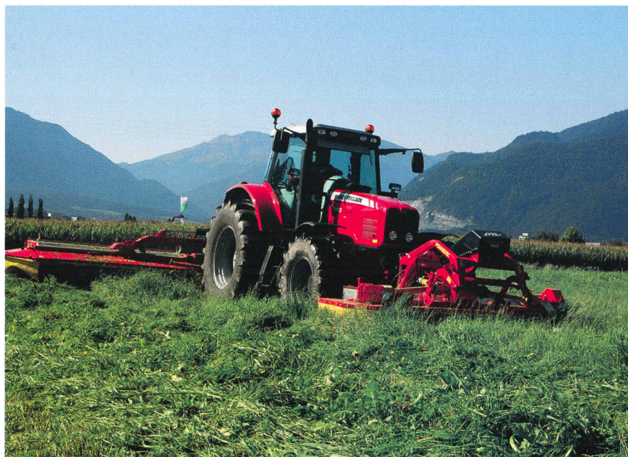
Tous les constructeurs ont optimisé leurs dispositifs d'attelage (attelages libres longitudinalement et perpendiculairement au sens de la course), ceci afin d'améliorer l'adaptation au sol. (Illustration Patricia Wolf)
