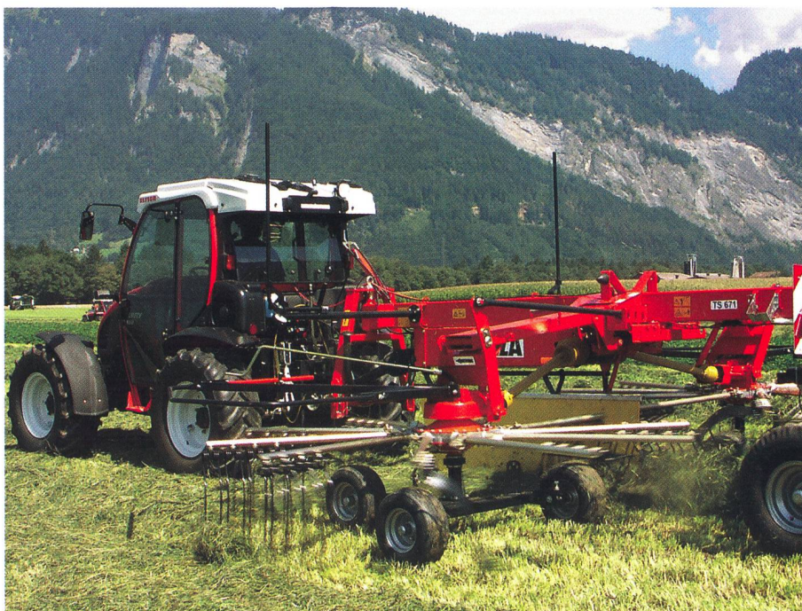
Les andaineurs doubles tractés s'adaptent parfaitement aux inégalités du terrain grâce à des roues de jauge et un essieu tandem. Un tracteur de faible puissance suffit pour ce type de machines.
