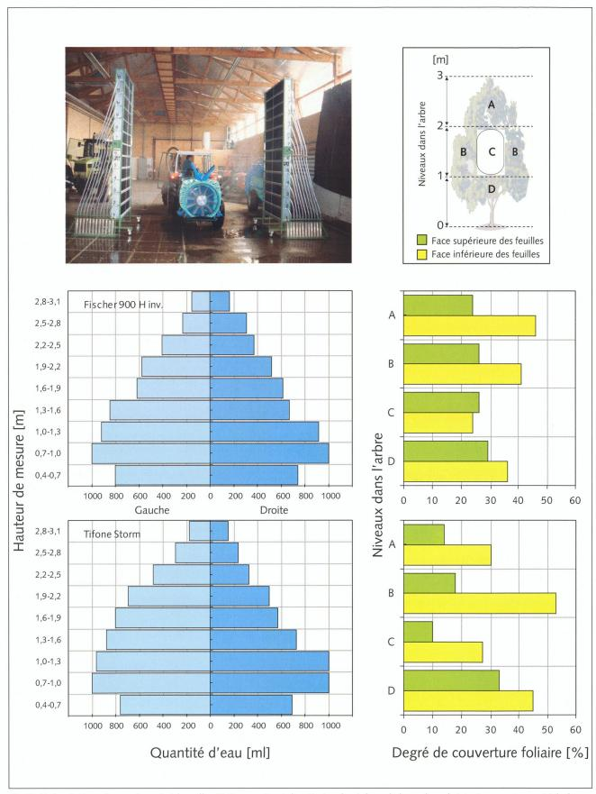
Fig. 5: En haut: Deux bancs d'essais à lamelles FAT permettent d'optimiser le réglage de base du pulvérisateur par rapport à la forme de l'arbre. A gauche: Exemples de répartition verticale d'eau. A droite: bien qu'on ait prévu une quantité plus faible d'eau dans la zone supérieure, pratiquement toutes les niveaux de mesure dans l'arbre affichent soit une bonne couverture foliaire, soit une couverture hétérogène (avec/sans déflecteur).
