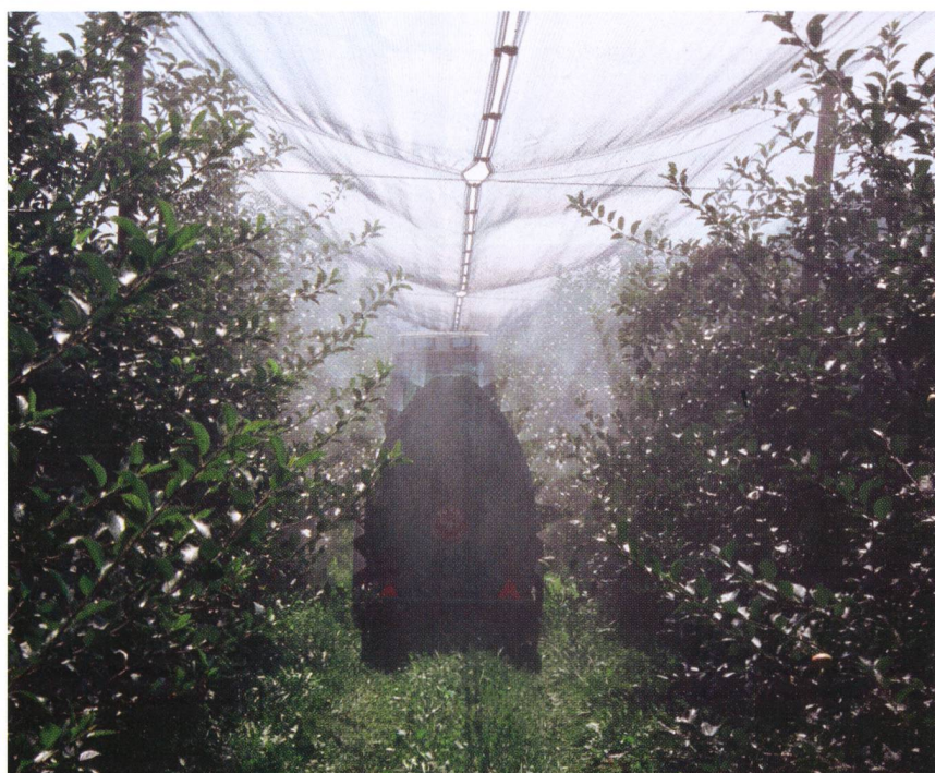
Fig. 1: Les pulvérisateurs équipés de souffluses axiales inversées avec déflecteur permettent d'appliquer les produits phytosanitaires dans le respect des plantes et de l'environnement (Fischer 900 Hi).
