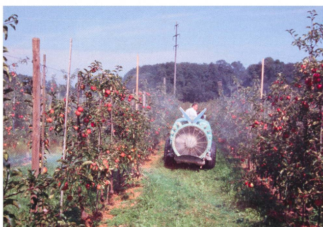
Fig. 4: Une haie d'arbres étroite exige une quantité de bouillie par hectare et un débit d'air réduits en conséquence. Souffleuse axiale sans déflecteur (Berthoud).
