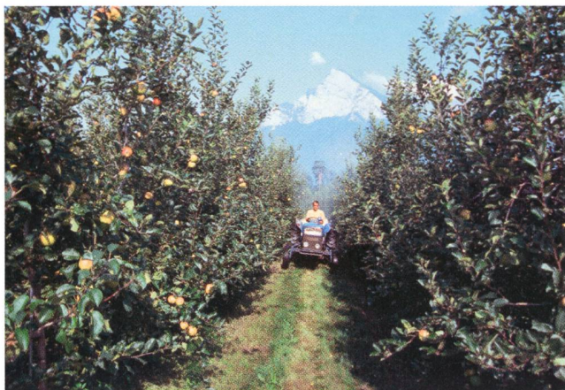
Fig. 2: Les plantations qui présentent un important volume d'arbres exigent que le débit d'air et la vitesse de progression de la machine soient bien adaptés. Un tel résultat peut être obtenu grâce au réglage manuel continu de l'angle des pales (Tifone).
