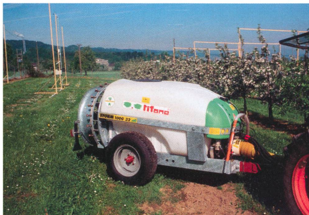
Fig. 2: Les plantations qui présentent un important volume d'arbres exigent que le débit d'air et la vitesse de progression de la machine soient bien adaptés. Un tel résultat peut être obtenu grâce au réglage manuel continu de l'angle des pales (Tifone).
