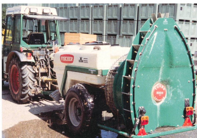
Fig. 3: Les remorques avec un timon d'attelage rotatif permettent de bien suivre la voie de passage et sont très maniables. L'air étant aspiré par l'avant, il n'y a pratiquement aucune réaspiration des gouttes (Fischer).
