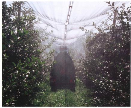
Fig. 1: Les pulvérisateurs équipés de souffleuses axiales inversées avec déflecteur permettent d'appliquer les produits phytosanitaires dans le respect des plantes et de l'environnement (Fischer 900 Hi).
