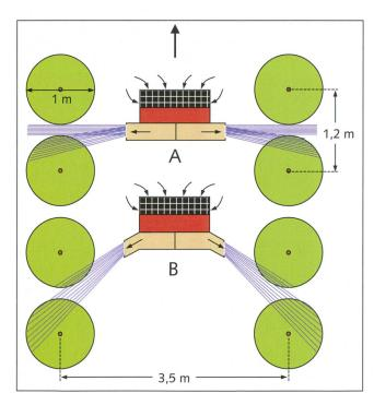
Fig. 10: Schéma du mode de fonctionnement du pulvérisateur avec souffleuse axiale inversée:
