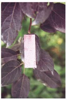
Fig. 6: La répartition verticale et le dépôt de produit sur les deux faces des feuilles (à droite) ont été contrôlés à l'aide de papier réagissant à l'eau.
