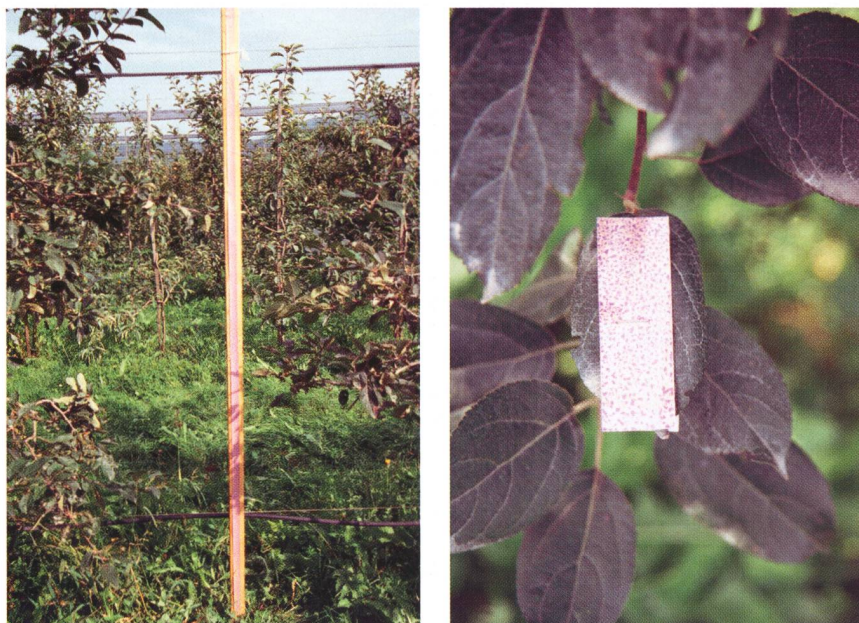
Fig. 6: La répartition verticale et le dépôt de produit sur les deux faces des feuilles (à droite) ont été contrôlés à l'aide de papier réagissant à l'eau.
