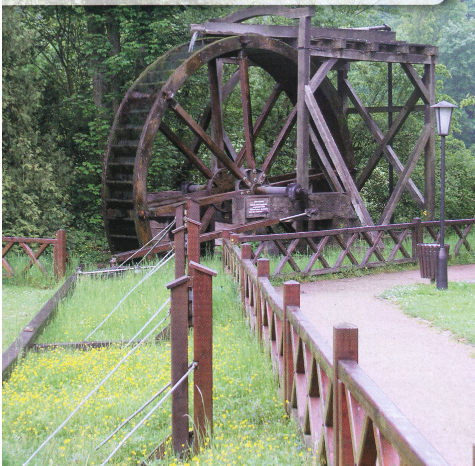
Exemple d'un système hydraulique à eau du XIX e siècle: le mouvement rotatif de la roue à eau était transmis par un «arbre» en bois et la force ainsi produite utilisée pour pomper l'eau salée du sous-sol.
