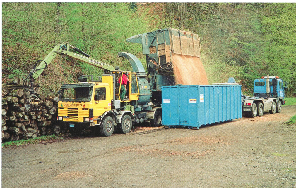
...dans la production de copeaux. La déchiqueteuse à trémie vide ses 20 mètres cube dans la benne
