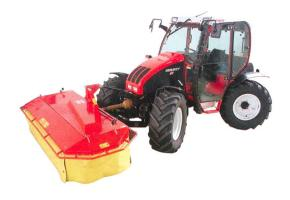
Tracteur de montagne REFORM Mounty 80 S, 6 cylindres – moteur turbo avec 59 kW (80 CV), inverseur synchronisé, système hydraulique frontal et prise de force frontale, poids 2860 kg (prix catalogue CHF 97 798.–), Rapport de test nº 1865/043. Extrait du rapport de test de la Bundesanstalt für Landtechnik BLT à Wieselburg (A).
