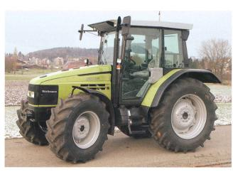
Tracteur HÜRLIMANN XT 95, 4-cylindres-moteur turbo, 67 kW (91 CV), boîte de vitesse à passage sous charge – 3 paliers, poids 4120 kg (prix catalogue CHF 87000.–), Rapport de test nº 1862/04.
