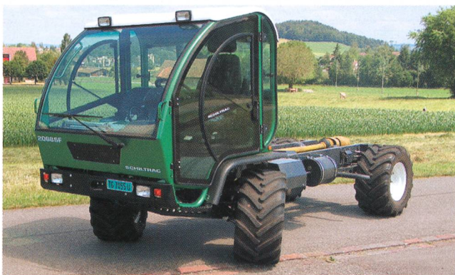
Transporteur SCHILTRAC 2068 SF, 4 cylindres – moteur turbo avec 65 kW (88 CV), boîte de vitesse à passage sous charge – 2 paliers, cabine confort, suspension essieu avant et arrière, poids à vide 2660 kg, poids total autorisé 7000 kg (prix catalogue CHF 107 600.-), Rapport de test – n° 1863/04.
