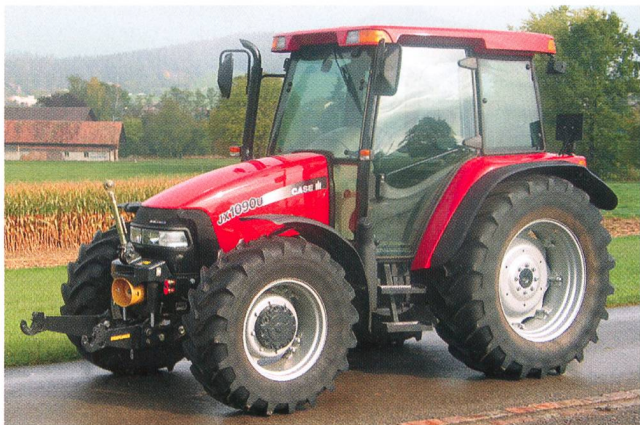
Tracteur Case IH JXU 1090U, 4 cylindres – moteur turbo avec 65 kW (88 CV), boîte de vitesse à passage sous charge – 2 paliers, système hydraulique frontal et prise de force frontale, poids 4370 kg (prix catalogue CHF 94900.-), Test tracteur – n° 1873/04.
