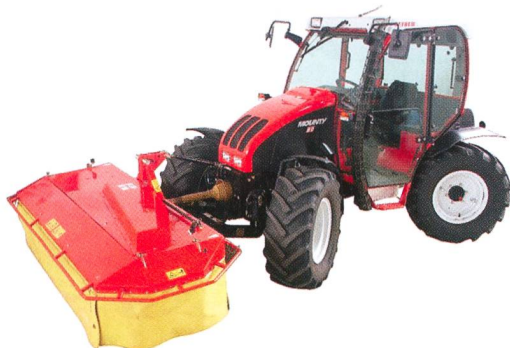
Tracteur de montagne REFORM Mounty 80 S, 6 cylindres – moteur turbo avec 59 kW (80 CV), inverseur synchronisé, système hydraulique frontal et prise de force frontale, poids 2860 kg (prix catalogue CHF 97 798.-), Rapport de test n° 1865/043. Extrait du rapport de test de la Bundesanstalt für Landtechnik BLT à Wieselburg (A).
