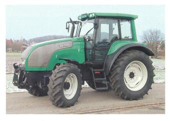
Tracteur VALTRA M130-4, 4-cylindres-moteur turbo avec refroidissement d'air de suralimentation, 95,5 kW (130 CV), boîte de vitesse à passage sous charge – 3 paliers, système hydraulique frontal, suspension de l'essieu avant, poids 5840 kg (prix catalogue CHF 127 840.-), Rapport de test nº 1859/04.
