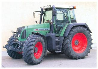
Tracteur FENDT 818 Vario, 6-cylindres-moteur turbo avec refroidissement d'air de suralimentation, 132 kW (180 CV), transmission automatique à fonctionnement continu, système hydraulique frontal, suspension de l'essieu avant, suspension de la cabine, poids 7150 kg (prix catalogue CHF 204 978.-), Rapport de test nº 1860/04.
