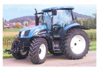
Tracteur NEW HOLLAND TS 110A, 4-cylindres-moteur turbo avec refroidissement d'air de suralimentation, 85 kW (116 CV), (Power Boost + 21,7 kW), boîte de vitesse à passage sous charge – 8 paliers, système hydraulique frontal et prise de force frontale, suspension de l'essieu avant, suspension de la cabine, poids 5790 kg, variante économique ECO-Tronic (prix catalogue CHF 138 070.–), Test tracteur nº 1874/04.
