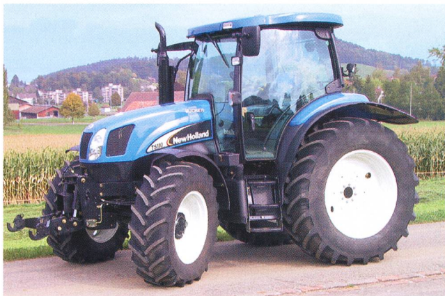
Tracteur NEW HOLLAND TS 110A, 4-cylindres-moteur turbo avec refroidissement d'air de suralimentation, 85 kW (116 CV), (Power Boost + 21,7 kW), boîte de vitesse à passage sous charge – 8 paliers, système hydraulique frontal et prise de force frontale, suspension de l'essieu avant, suspension de la cabine, poids 5790 kg, variante économique ECO-Tronic (prix catalogue CHF 138070.-), Test tracteur n° 1874/04.
