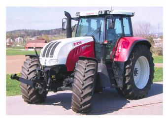
Tracteur STEYR CVT 6170, 6-cylindres-moteur turbo avec refroidissement d'air de suralimentation, 114 kW (155 CV), transmission automatique à fonctionnement continu, système hydraulique frontal, suspension de l'essieu avant, suspension de la cabine, poids 7490 kg (prix catalogue CHF 180 450.–), Rapport de test n° 1861/04.
