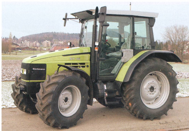
Tracteur HÜRLIMANN XT 95, 4-cylindres-moteur turbo, 67 kW (91 CV), boîte de vitesse à passage sous charge – 3 paliers, poids 4120 kg (prix catalogue CHF 87000.-), Rapport de test n° 1862/04.
