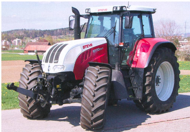
Tracteur STEYR CVT 6170, 6-cylindres-moteur turbo avec refroidissement d'air de suralimentation, 114 kW (155 CV), transmission automatique à fonctionnement continu, système hydraulique frontal, suspension de l'essieu avant, suspension de la cabine, poids 7490 kg (prix catalogue CHF 180 450.-), Rapport de test n° 1861/04.
