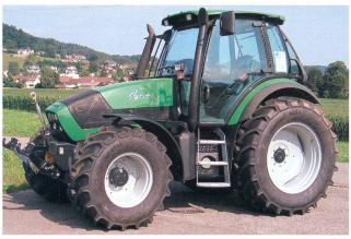
Tracteur DEUTZ-FAHR Agrotron 118, 6-cylindres-moteur turbo avec refroidissement d'air de suralimentation, 93,5 kW (127 CV), boîte de vitesse à passage sous charge - 4 paliers, système hydraulique frontal et prise de force frontale, suspension de l'essieu avant, suspension de la cabine, poids 6250 kg (prix catalogue CHF 125 300.-), Test tracteur - nº 1867/04.
