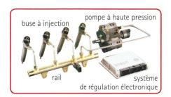
Fig. 1: Dans le système d'injection Common Rail, une pompe d'alimentation à basse pression amène le carburant, au travers d'un filtre, à une pompe à haute pression. Celle-ci pompe le carburant dans le conduit à haute pression (rail). Le système de conduction d'injection à haute pression relie toutes les valves magnétiques des injecteurs. Les valves magnétiques des injecteurs sont régulées électroniquement.
