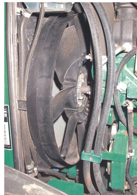
Fig. 6: Le ventilateur à coupleur viscothermostatique adapte la vitesse de rotation et donc le taux de refroidissement aux besoins du moteur, au moyen d'un couplage automatiquement régulé des liquides.
