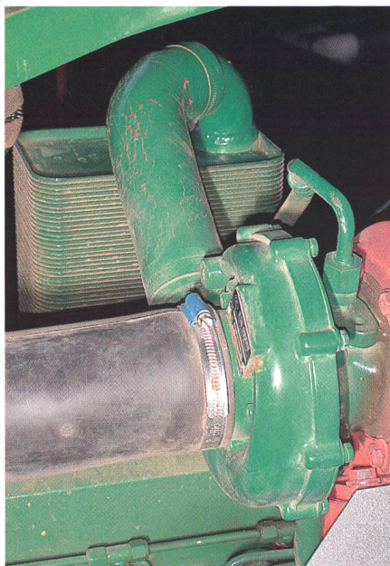
Fig. 5: Le refroidisseur d'air de suralimentation refroidi à l'eau (p. ex. John Deere) est de taille plus petite et peut être installé quasi librement. L'air de suralimentation ne peut être refroidi, au mieux, qu'au niveau de la température du liquide refroidissement.
