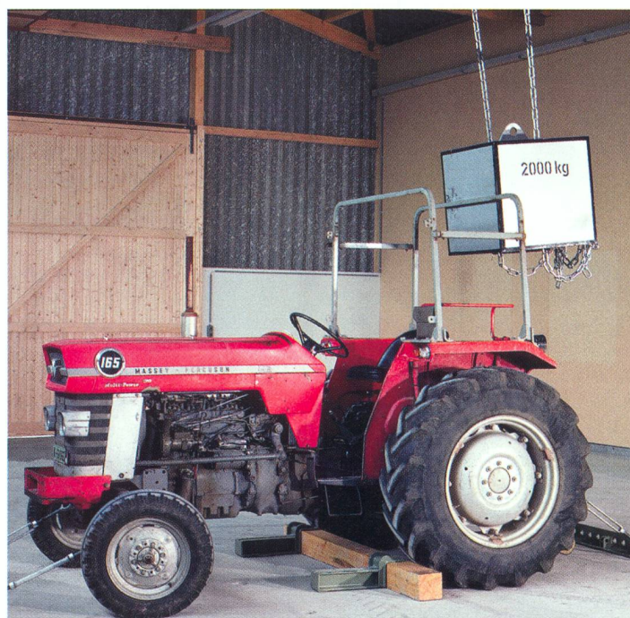
1978: L'arceau de protection obligatoire demande à la FAT de disposer d'un banc d'essai. Les méthodes actuelles pour garantir la sécurité du conducteur en cas d'accident se testent aujourd'hui avec des cylindres hydrauliques, méthode plus douce qu'à l'époque.
