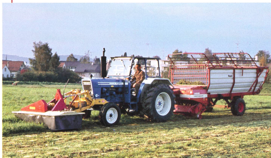
Le tracteur standard avec prise de force frontale et l'hydraulique. Mais l'essieu n'est pas à la hauteur de sa tâche.
