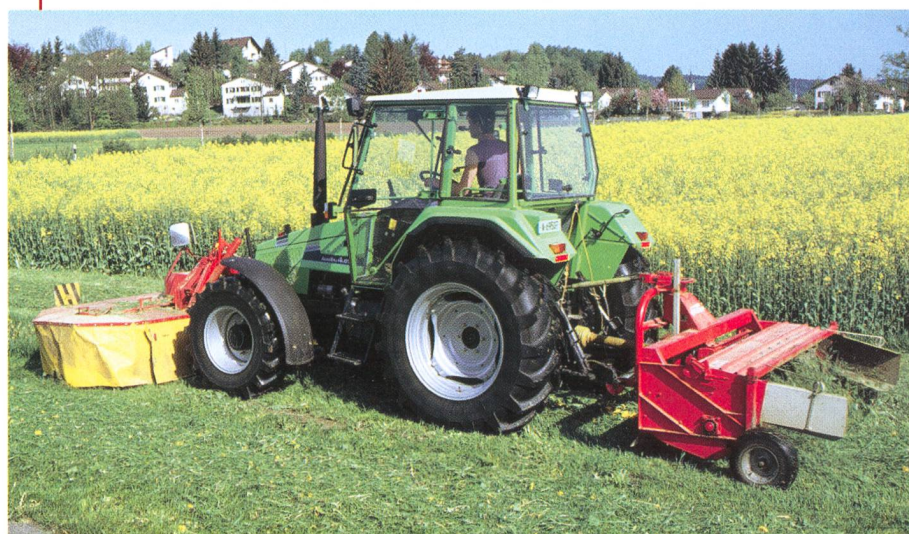
Le tracteur standard avec prise de force frontale et l'hydraulique. Mais l'essieu n'est pas à la hauteur de sa tâche.
