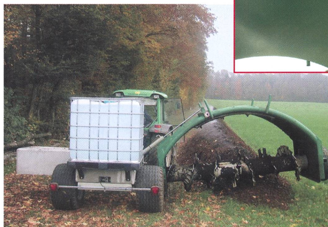
Simplification du travail: Tank de 1000 litres permettant un arrosage de l'andain à l'aide des buses fixées sous le tunnel.
