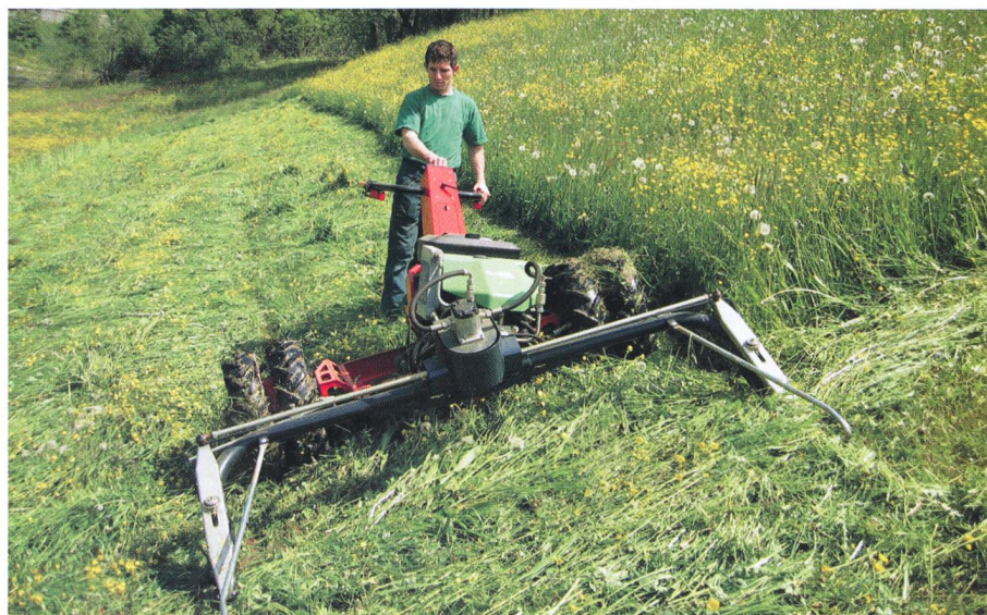
Rapid Tecno avec entraînement hydraulique de la machine et des outils. (Photo d'usine)
