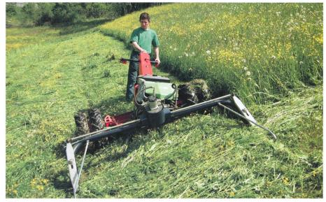
Rapid Tecno avec entraînement hydraulique de la machine et des outils. (Photo d'usine)
