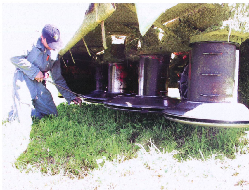
Fig. 1: Le changement des couteaux réduit la consommation de carburant.
