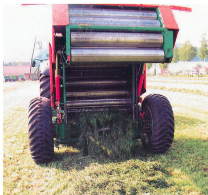
Fig. 7 et fig. 8: Les mesures ont été réalisées en deux étapes. Dans un premier temps, l'andain a été ramassé, coupé et redéposé (mesure du besoin en puissance). Dans un deuxième temps, la récolte a été pressée en balles (mesure du rendement).
