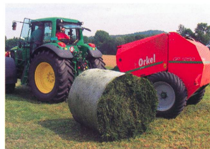
Fig. 7 et fig. 8: Les mesures ont été réalisées en deux étapes. Dans un premier temps, l'andain a été ramassé, coupé et redéposé (mesure du besoin en puissance). Dans un deuxième temps, la récolte a été pressée en balles (mesure du rendement).
