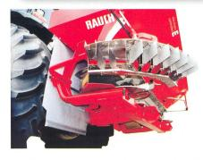
Le Telimat, accessoire pour la commande à distance de l'épandage en bordure de champ, est introduit dans le flux d'engrais par un dispositif hydraulique et permet un épandage précis, quelle que soit la largeur de travail. Avec le Telimat, les normes UE sur l'environnement pour les épandeurs d'engrais EN 13739-1 sont respectées.
