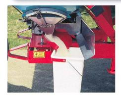
L'étalonnage du débit est réalisé à vitesse réelle, car le récipient de récupération se place et reste maintenu directement sous le flux d'engrais.
