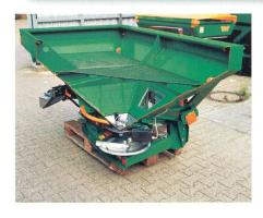
Amazone souligne la prise en charge régulière et soigneuse des granulés d'engrais sur les disques d'épandage, à proximité de leur centre de rotation, ceci grâce à un élément agitateur spécialement conçu dans le canal de guidage.
