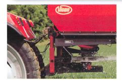
Pour l'épandage en bordure de champ, les modèles RotaFlow peuvent être équipés soit d'un déflecteur de bordure (pour rouler en bord de champ), soit d'un cylindre de biais (pour rouler dans la première voie de passage). De plus, les modèles RS-XL et RS-EDW disposent en option du «TrimFlow System», analoque au Telimat de Rauch.
